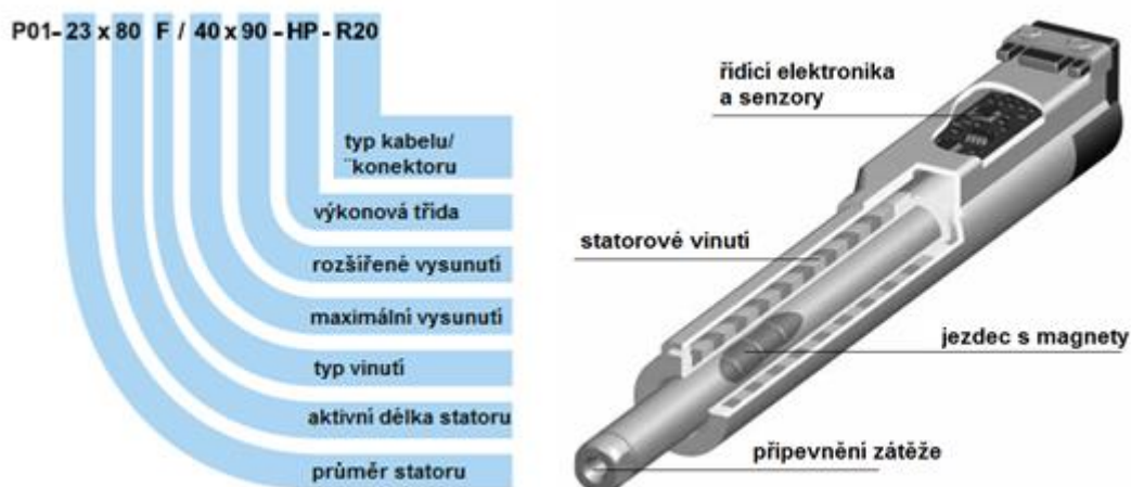
OBR. 2.7 – SYSTÉM ZNAČENÍ MOTORŮ LINMOT, USPOŘÁDÁNÍ MOTORŮ [1]
